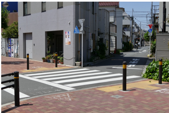
都道 317 号と細街路の交差点 (中落合三丁目)。自転車歩行者道と車道が直角で交差するように車道を折り曲げている。2016 年 5 月に筆者が撮影。
