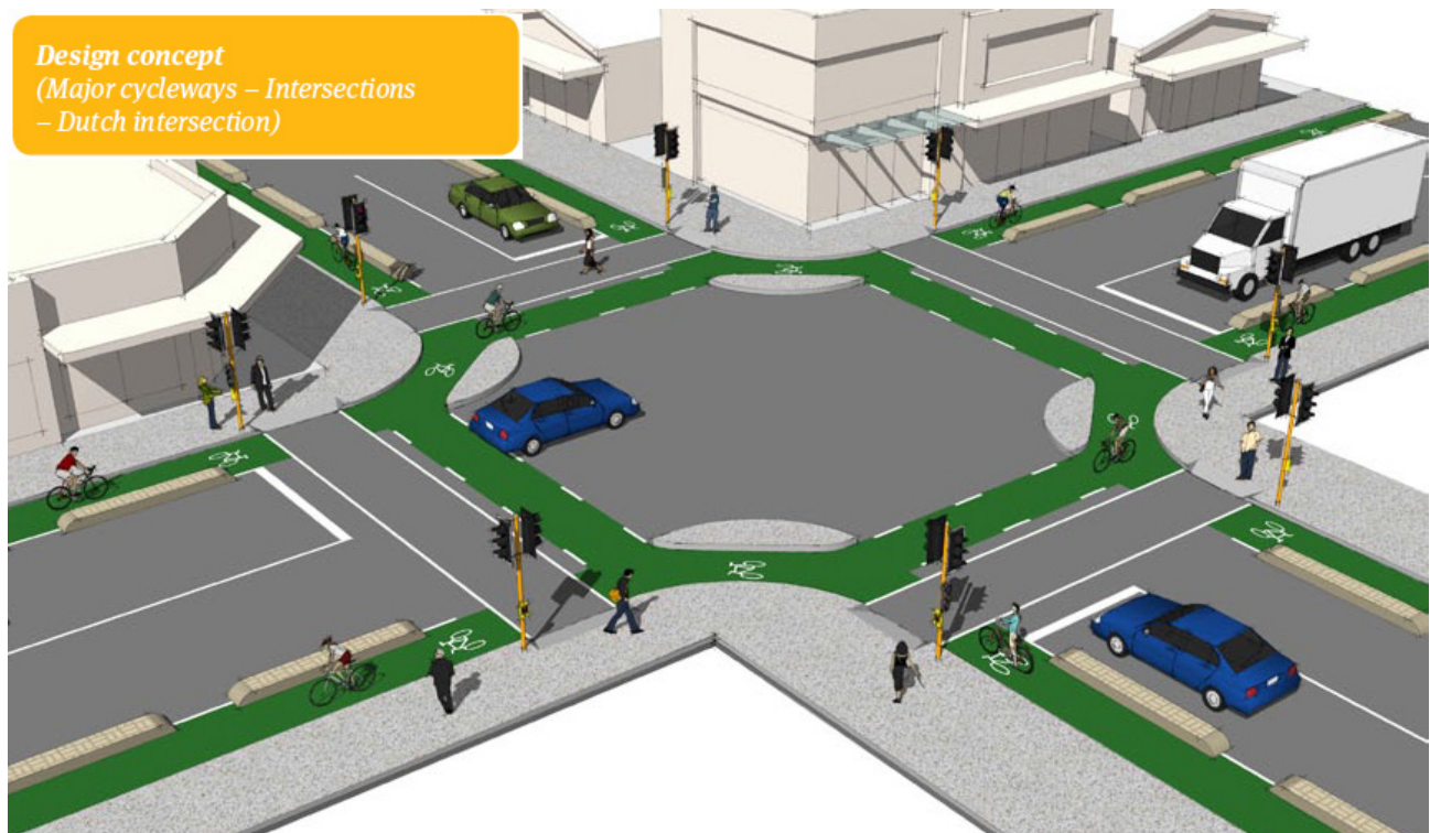
クライストチャーチの交差点設計案。自転車の停止線の位置が車と変わらず、交差点角の線形も極めて悪い。 出典：Mark Wagenbuur (2014-02-23)
