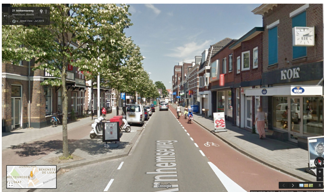
アームスフォートの商店街通り (Arnhemseweg)。左側が自転車道、右側が自転車レーン (fetsstrook met onderbroken streep)。 出典：Google Maps Street View (2015-07@52.1507138,5.3850163)
