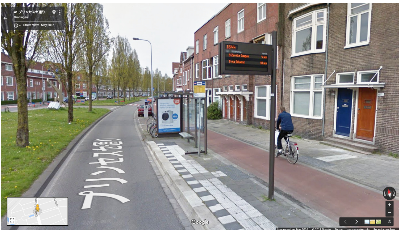
フローニンゲンの Prinsesseweg。緩衝帯に街路灯、駐輪ラック、路上駐車枠などと共にバス停のシェルターを取めている。 出典：Google Maps Street View (2016-05@53.2213617,6.5476463) ※オリジナル画像に色調調整を加えた。
