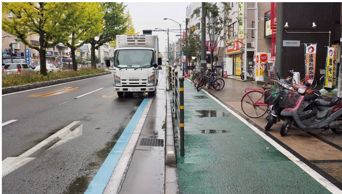
松山市の平和通り (市道中央循環線)。路上駐車に塞がれない自転車通行空間が整備されている。2016年10月に筆者が撮影。
