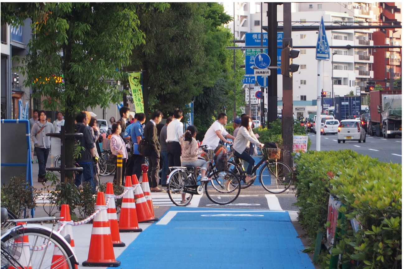
都道317号の中落合の自転車歩行者道。ゴミ集積やスーパー来店客の駐輪需要を考慮せず空間配分した為、自転車通行空間が塞がっている。更に画面奥にはバス停の乗降空間も有るので自転車通行空間がその手前で打ち切られている。2016年5月に筆者が撮影。
