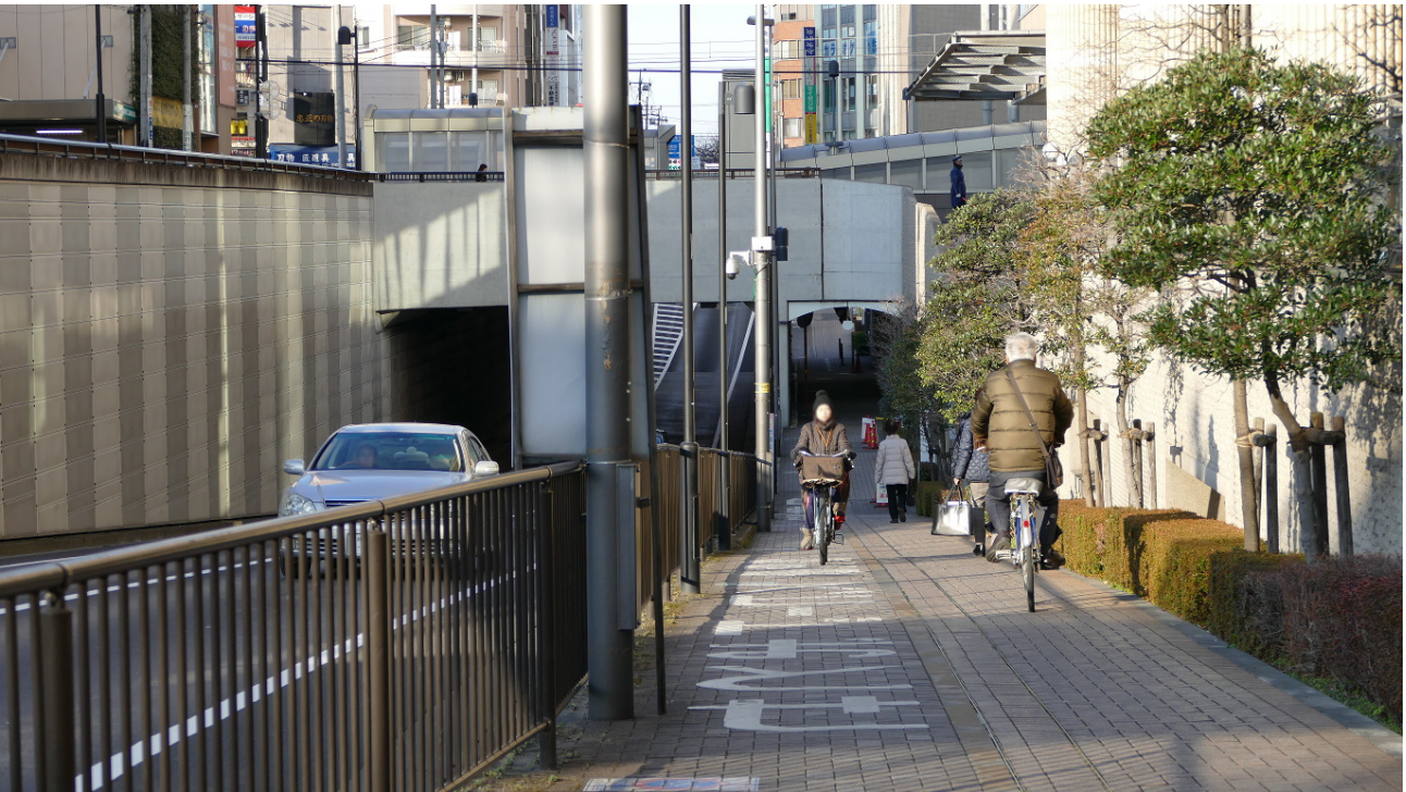
練馬主要区道39号線の大泉学園駅アンダーパス。舗装の色で歩道が二分され、自転車と歩行者を分離する意図が見えるが、そもそも絶対的な幅員が狭く、自転車と歩行者が交錯しやすい。2017年1月に筆者が撮影。
