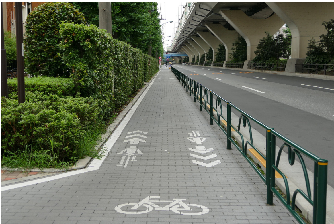
都道 446 号の高島平付近の自転車道。植栽 (高さ 2m) や通行帯内の柵 (高さ 0.8m) で左右からの圧迫感が強い。 2016 年 7 月に筆者が撮影。
