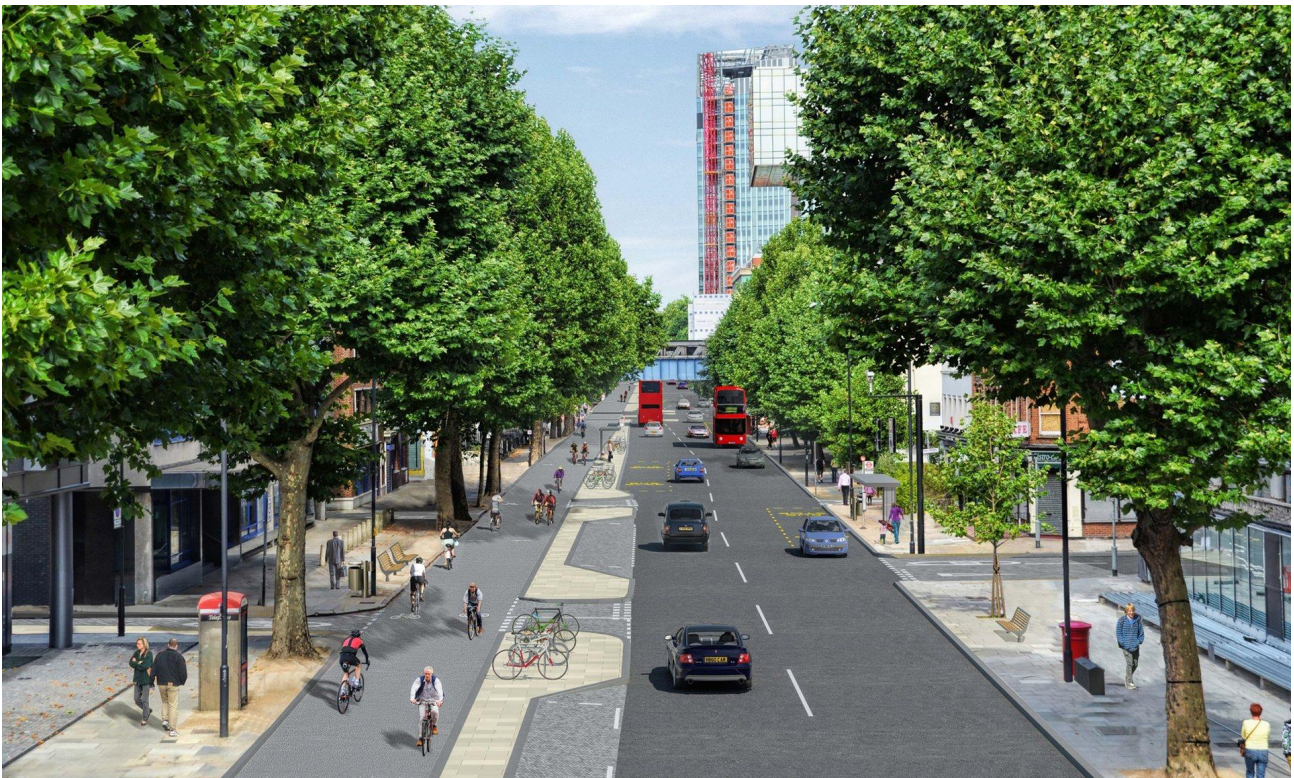
ロンドンの east-west cycle superhighway の完成予想図。交差点の数メートル手前でパーキング・ベイを打ち切り、細街路に出入りする車からの自転車道の見通しを良くしている。出典：Peter Walker (2015-01-28)
